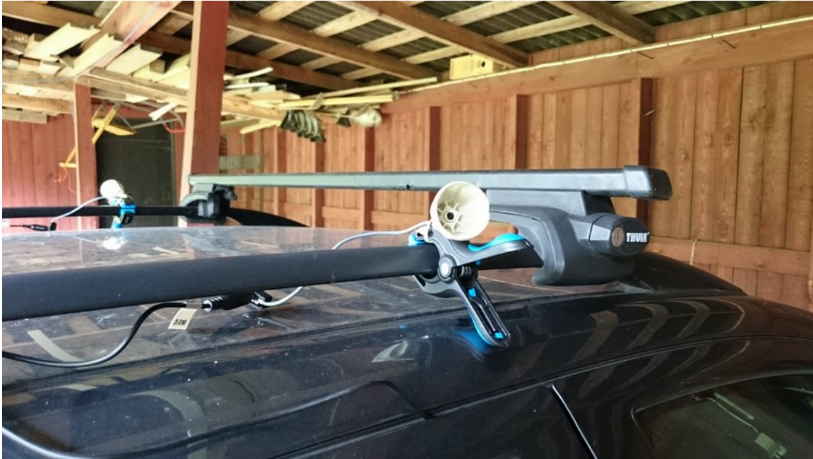
Kuva 2. Auton katolle sijoitetut mikrofonit tuulisuojineen.
